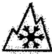
Рисунок 5.1. Маркировка, наносимая на зимнюю шину
