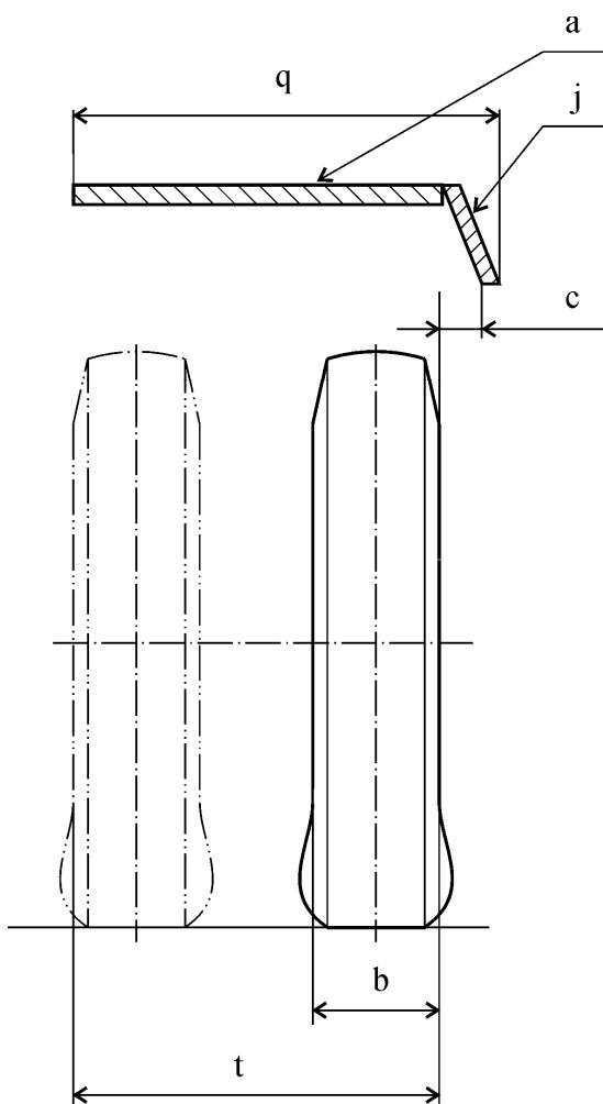
$a$  – грязезащитный кожух;  $j$  – наружная боковина;  $c$  – расстояние между боковой поверхностью шины и наружной боковиной;
