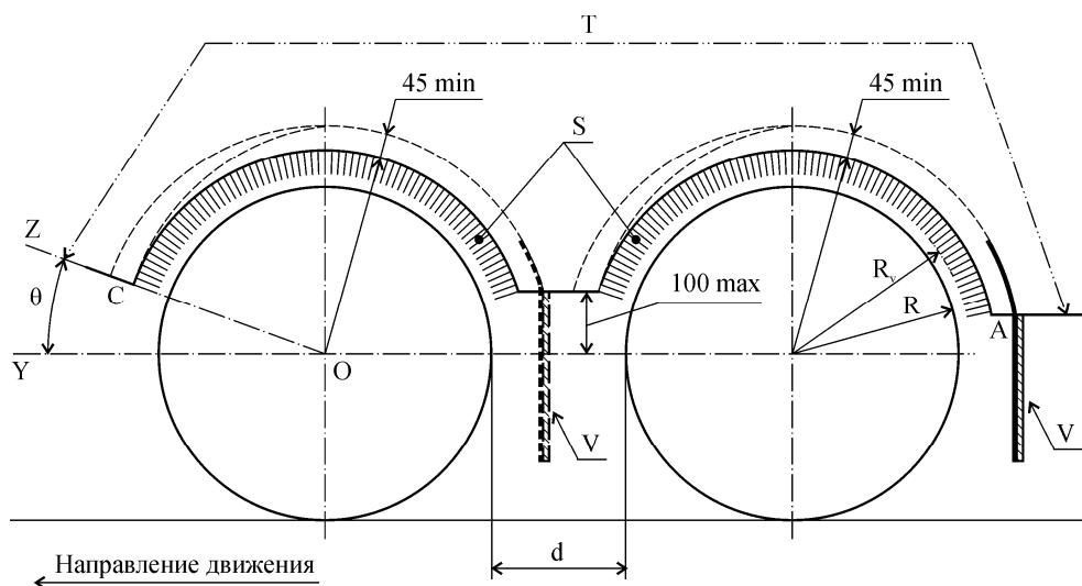
$j$  – наружная боковина;  $\theta$  – угол между горизонталью ( $O - Y$ ) и плоскостью, проходящей через ось колес ( $O - Z$ );  $S$  – сепаратор «воздух-вода»;
