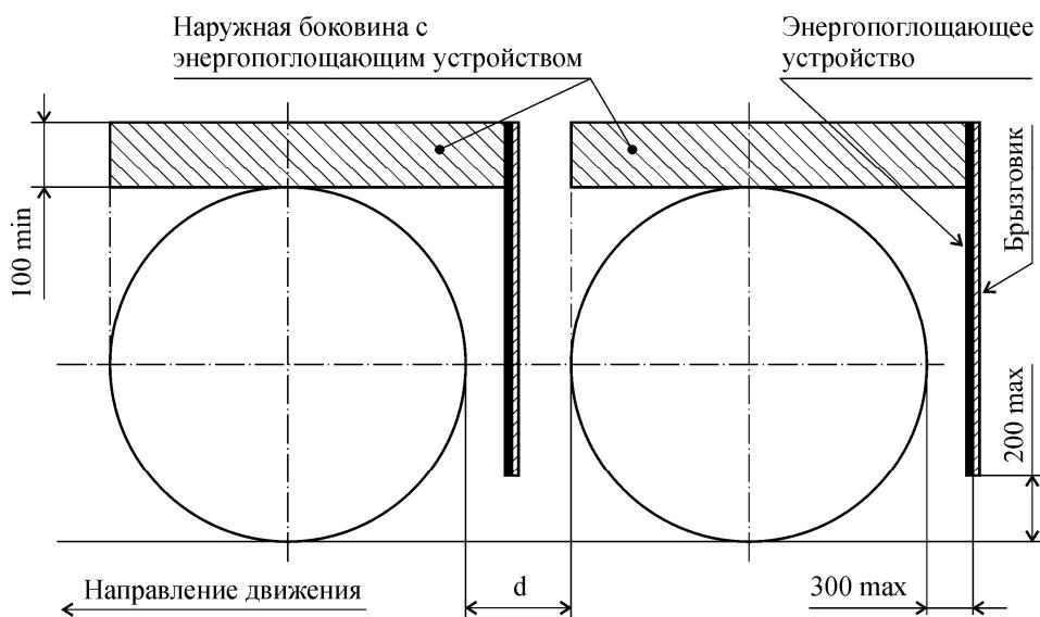
Рисунок 9.4 – Схема системы защиты от разбрзгивания с энергопоглощающими устройствами для осей с неуправляемыми и самоустанавливающимися колесами
