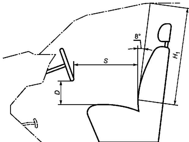
Рисунок 1.6.1. Размеры, которые должны быть выдержаны в кабине
