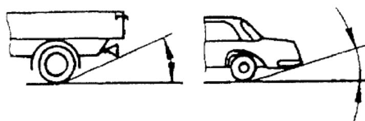
Рисунок 2. Угол съезда
