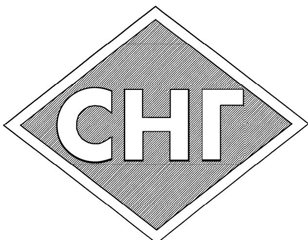
Рисунок 11.1. Образец опознавательного знака для транспортных средств категорий M<sub>2</sub> и M<sub>3</sub>, использующих в качестве топлива сжиженный нефтяной газ (СНГ) или компримированный природный газ (КПГ)
