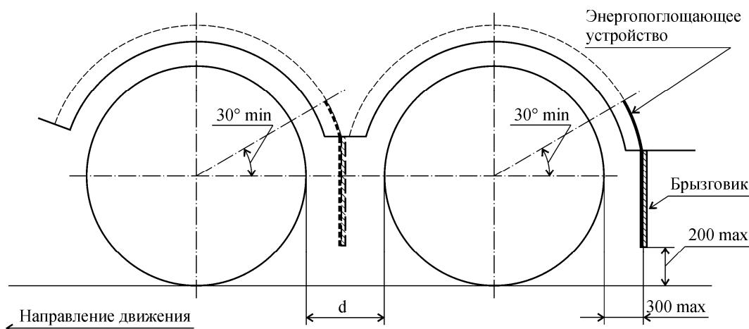
$d \leq 300$  мм – расстояние между шинами, установленными на соседние оси;
